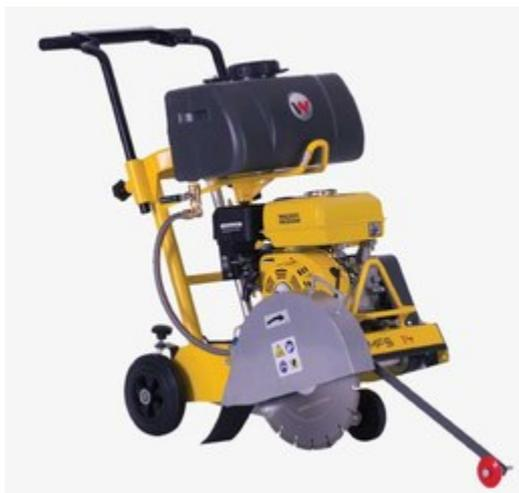
Новинка от Wacker Neuson, бензиновый нарезчик швов М-серии. Диаметр алмазного диска 350 мм. Подача воды, настройка глубины реза, удобная система управления.
